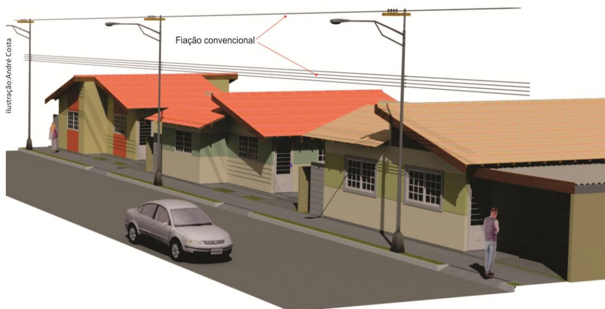
CALÇADA COM LARGURA INFERIOR A 1,50m
